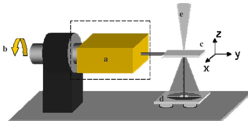
*Figure 1* – Schéma du dispositif « Tomo-STEM » : a) système de réglage de l'eucentrique ; b) génération de rotation de 360° ; c) échantillon ; d) détecteur à deux secteurs semi-annulaires, e) faisceau d'électrons incidents
