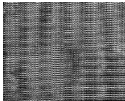
Figure 3 - ZnO vue plane, amincissement ionique classique jusqu'à 100V
